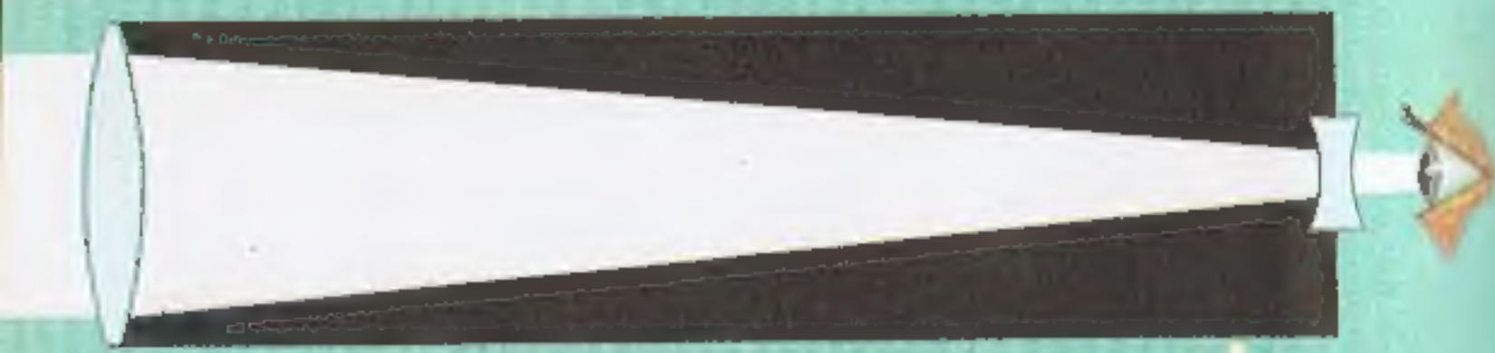
يحتوي تلسكوب غاليليو عدسة عينية مقعرة، وتظهر في الأشياء المنظورة قائمة
